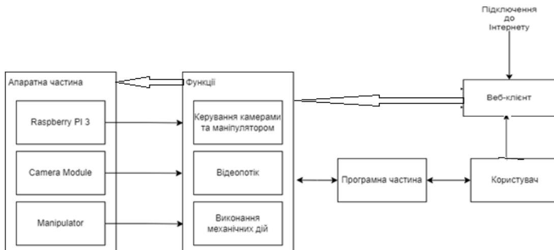
Рисунок. Загальна структура апаратно-програмної системи для дистанційного контролю робота
